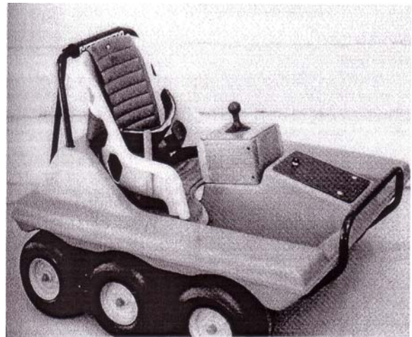
РИСУНОК 27-12. Моторизированный игрушечный автомобиль со встроенным специальным сиденьем и джойстиком. (Автомобиль адаптирован S. Shores, Good Samaritan Hospital, Puyallup, WA).
